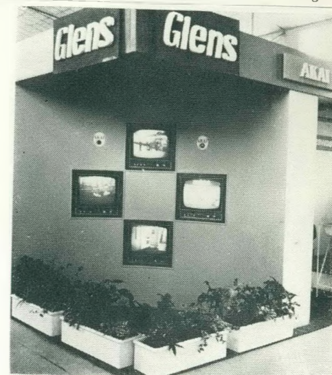
Die Akai geslote stroom-baan beeld-monitor eenhede gemonteer in Glens se pawiljoen by die Randse Skou, het verbygangers laat sien wat aangaande was in die klankkamer, by die Kenwood demonstrasie en die Philco vertoning. Deur 'n video kamera wat agter 'n Akai-teken weggesteek is, het die boonste beeldstel die toneel onmiddellik voor, en die toeskouer, weer-spieël.
